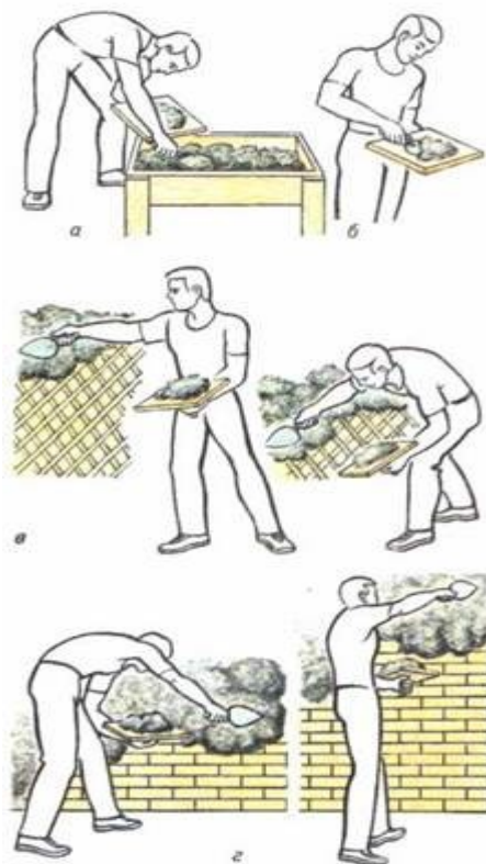
Рисунок 4 – Нанесение штукатурного раствора кельмой на стены: а - накладывание раствора на сокол; б - забираение раствора кельмой с сокола; в - нанесение раствора в положении слева направо на разных уровнях; г - то же, справа налево.
