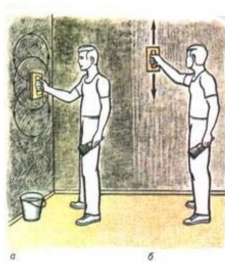
Рисунок 7 – Затирка штукатурки тёркой вкруговую (а) и вразгонку (б).
