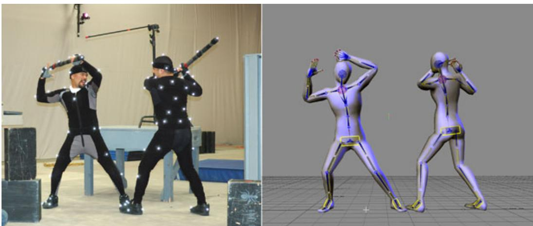
Рис. 33. Маркерная оптическая активная система Motion capture
