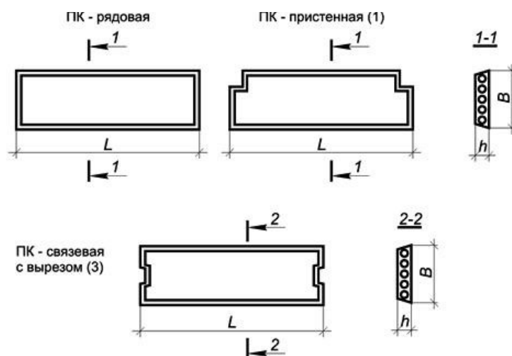
Рисунок 5 – Виды плит перекрытий каркасных зданий
