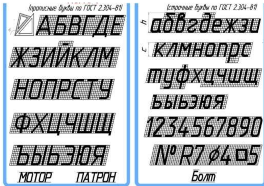
Рисунок 3.2 – Шрифт типа Б с наклоном
