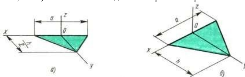
Рисунок 8.5 – Аксонометрические проекции треугольника: а - фронтальная диметрическая; б - изометрическая
