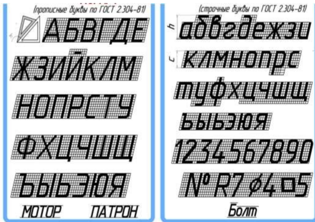
Рисунок 3.2 – Шрифт типа Б с наклоном
