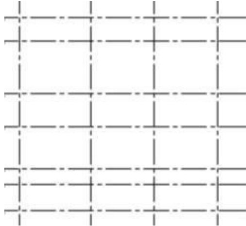
Рисунок 36 – Вычерчивание координационных осей
