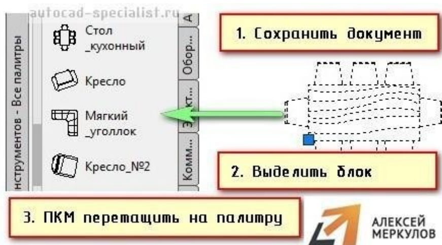
Рисунок 7 – Собственная библиотека блоков для AutoCAD может быть дополнена новыми объектами.
