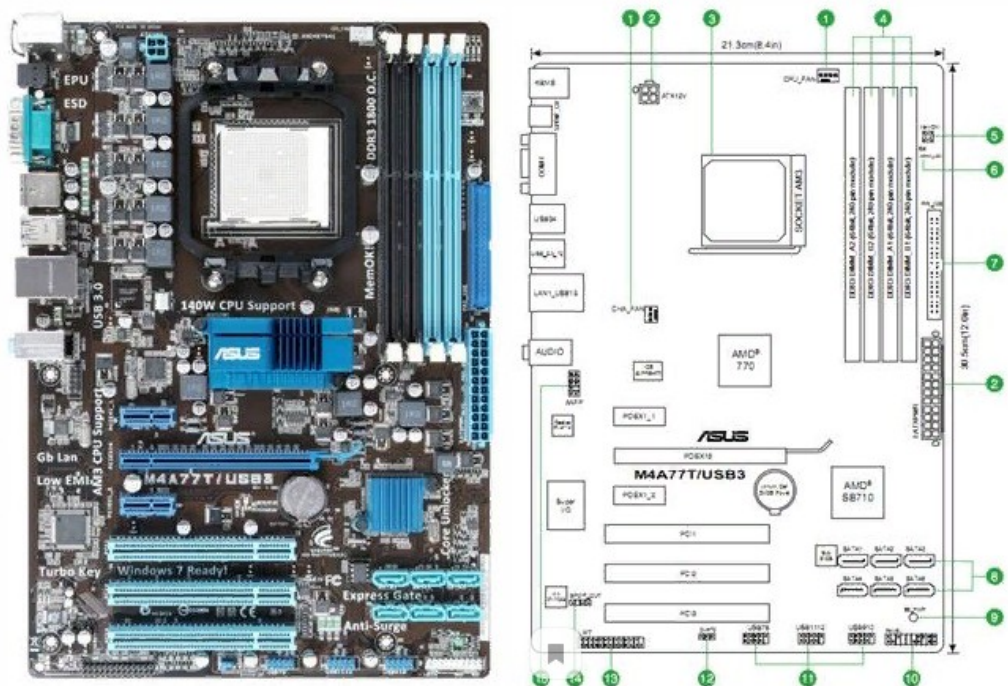
Рис. 6 Материнская плата ASUS M4A77T-USB3, внешний вид и схема расположения элементов:
