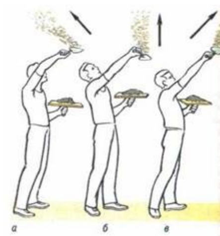
Рисунок 5 – Нанесение раствора кельмой на потолок: а - через плечо; б - над собой; в - от себя.
