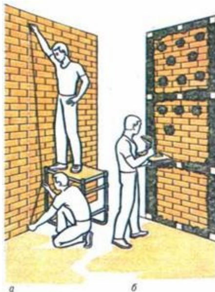
Рисунок 9 – Облицовка кирпичных поверхностей гипсокартонными листами: а – провешивание стен с забивкой гвоздей; б – нанесение мастики между опорными марками.
