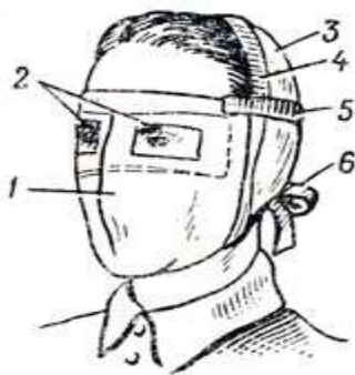
Рис. 108. Противопыльная тканевая маска ПТМ-1: 1 - корпус маски; 2 - смотровые отверстия; 3 - крепление; 4 - резиновая тесьма; 5 - поперечная резинка; 6 - завязки
