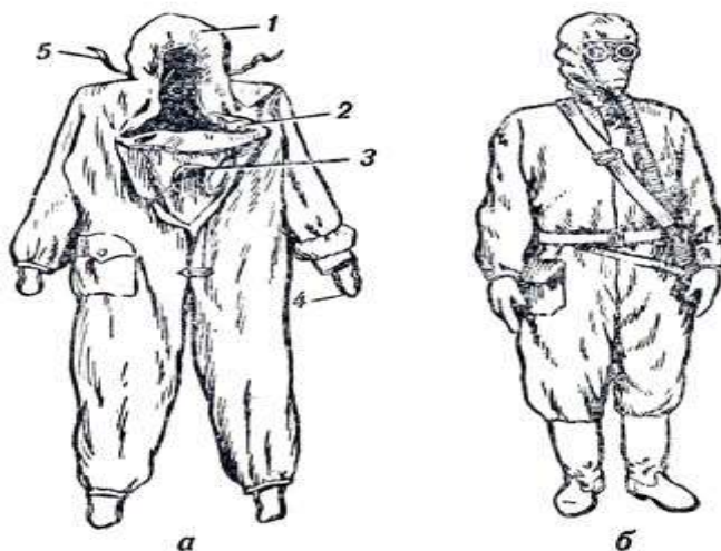
Рис. 112. Комбинезон защитной фильтрующей одежды (ЗФО): а - общий вид; б - ЗФО в 'боевом' положении: 1 - капюшон; 2 - нагрудный клапан комбинезона; 3 - горловой клапан; 4 - штрипки подрукавников; 5 - вздержки
